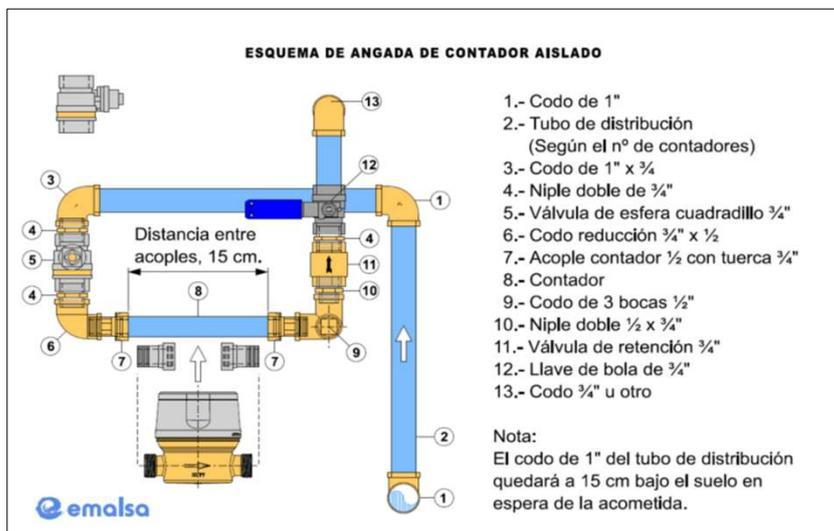
**NOTA:** Los accesorios utilizados en los trabajos deben ser de latón, las tuberías en las angadas individuales y cuadros serán de PVC roscable, se permite tuberías en Termofusión para cuadros  $\geq 2$  contadores en interior del inmueble.
