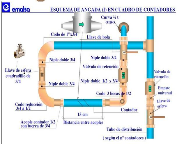
**NOTA:** Los accesorios utilizados en los trabajos deben de ser de latón, las tuberías PVC roscable, no se utilizará ni tubería de cobre ni de pegue.
